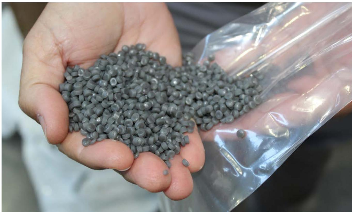
Granulado de polietileno 100% reciclado a partir do qual são fabricados os sacos Valorfito
