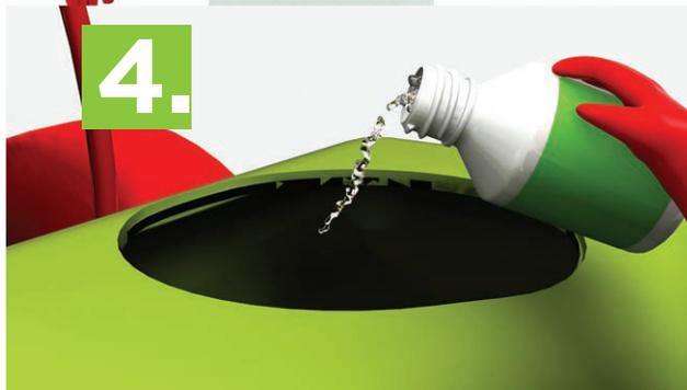
Deitar a água da lavagem no depósito de pulverização;
